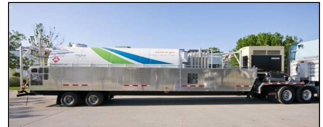
Mobile LNG Station
